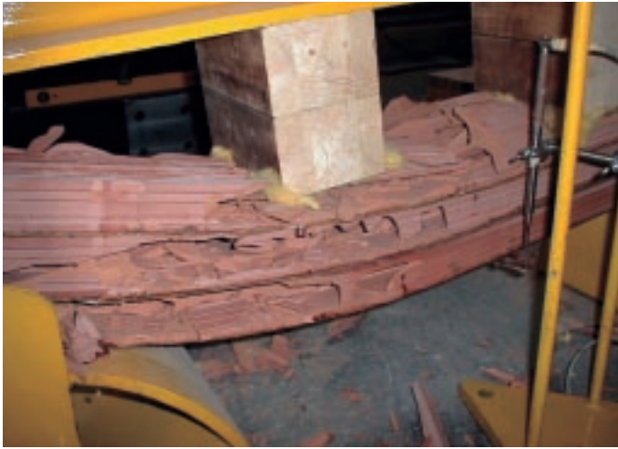
4. Comportamento a rottura degli elementi "multistrato" (tre tavelloni) L=150 cm.
