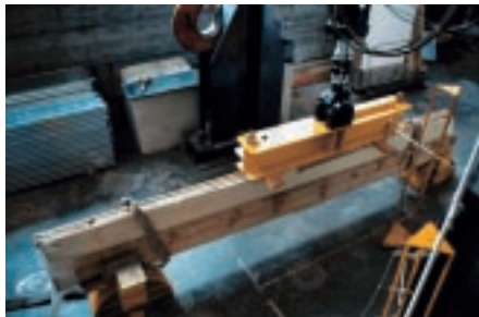
11. Architravi: soluzioni classiche e in laterizio "multistrato" fibrorinforzato con FRP.
