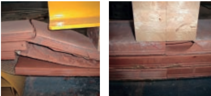
4. Comportamento a rottura degli elementi "multistrato" (tre tavelloni) L=150 cm.
